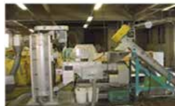
食品付着物・土砂などの洗浄 金属類は比重分別
