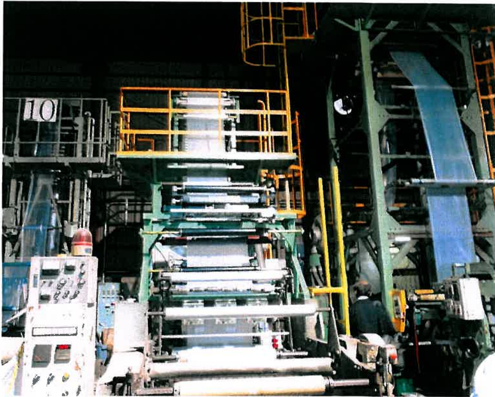
テストは 2 台のインフレーション成形機で実施
