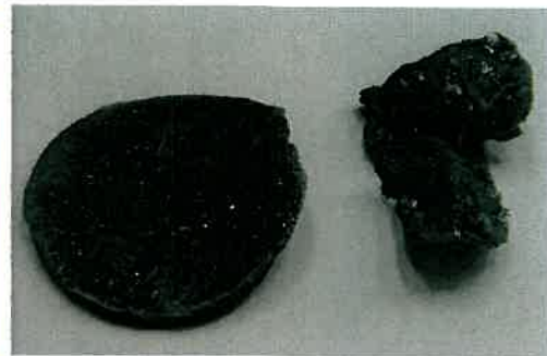
網状スクリーン・右は金属片の付着したスクリーン
